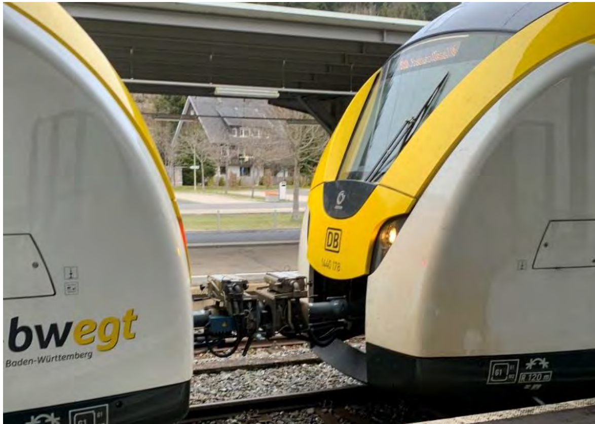
Abbildung 6: Kuppelvorgang im Bahnhof Titisee (Foto: Ramboll)
